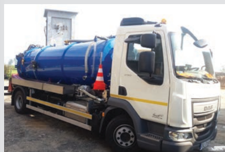
Zakupiony specjalistyczny samochód do obsługi sieci kanalizacyjnej.
